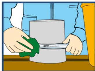
Es aconsejable tensionar el tubo a medida que se dobla para evitar arrugas en la parte interior de la curva. Tan pronto la curva esté formada, debe enfriarse con un trapo mojado en agua fría.
