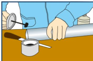
Una el tubo con el accesorio asegurándose de un buen asentamiento y dele un cuarto de vuelta para distribuir la soldadura, manteniendo firmemente la unión por 30 segundos.
