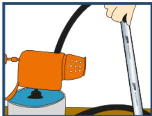
El tubo se calienta más eficazmente insertándole en un tubo de acero de diámetro mayor, colocado sobre una mesa formando un hornillo y girándolo continuamente.
